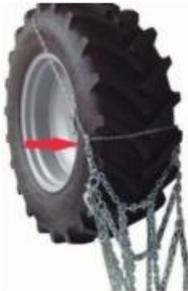
**DE** Schneeketten vor oder hinter dem Rad ausbreiten und ordnen. Spannhebel und Spannkette nach außen positionieren. Montagekette/-seil über die obere Hälfte des Reifens legen und die Kette an den Montagehaken einhängen.
