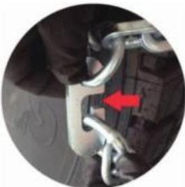
DE Seitenkette auf der Radinnenseite schließen (Seitenhaken im letzten Ring der Seitenkette einhängen); anschließend auch auf der Radaußenseite. Hinweis: Nach dem Einhängen prüfen: Kettenstränge dürfen nicht verdreht sein.
