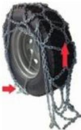
DE Langsam eine Radumdrehung fahren, Kette zieht sich dabei auf den Reifen. Schneekette von Montagekette/-seil lösen. Montagekette/-seil herausziehen.
