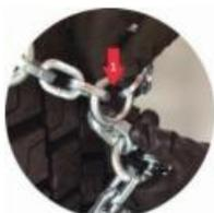
**DE** Mittelverschluss/Laufflächenhaken anheben und in den Ring über die Flachstelle einhängen.
