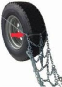
DE Schneeketten vor oder hinter dem Rad ausbreiten und ordnen. Spannhebel und Spannkette nach außen positionieren. Montagekette/-seil über die obere Hälfte des Reifens legen und die Kette an den Montagehaken einhängen.
