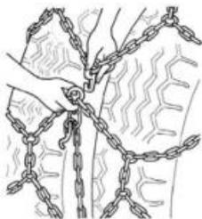
**DE** Den Mittelhaken der Kette in den entsprechenden Ring einhängen. Den Mittelteil der Kette mit der dafür vorgesehenen Spannkette spannen.
