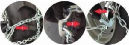
**DE Passform anpassen:** Die Passform der Kette kann durch Kürzen der Innenkette verändert werden. Mittels Schäkeln kann die Länge der Innenkettenabschnitte variiert werden. Die Verkürzungsstellen gleichmäßig verteilen – die einzelnen Innenkettenteile sollen nach dem Verkürzen möglichst gleich lang sein.
